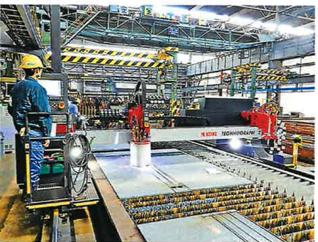
稼働を開始した400A門型プラズマ切断機（印字機能とガス溶断トーチ2本も装備）
