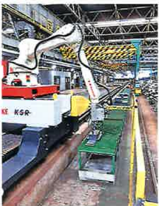
レーザ定盤に共載した「片付けロボット」④、ロボットが自動で片付け用架台に切板を積み上げる
