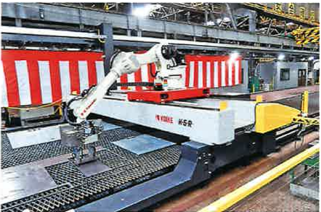
レーザ定盤に共載した「片付けロボット」④、ロボットが自動で片付け用架台に切板を積み上げる
