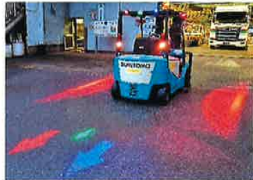
フォークリフトにLEDライトを取り付け
