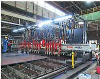
ガス流量の自動制御・火炎調整最適化装置でキャンバ―発生を抑制
