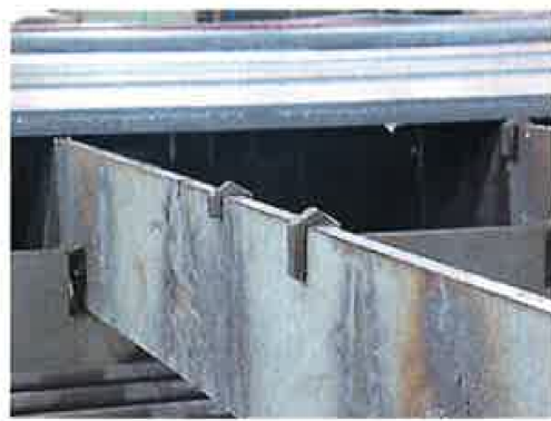
ガス溶断定盤の挿し 板に治具を取り付け 「跳ね返り」防止に
