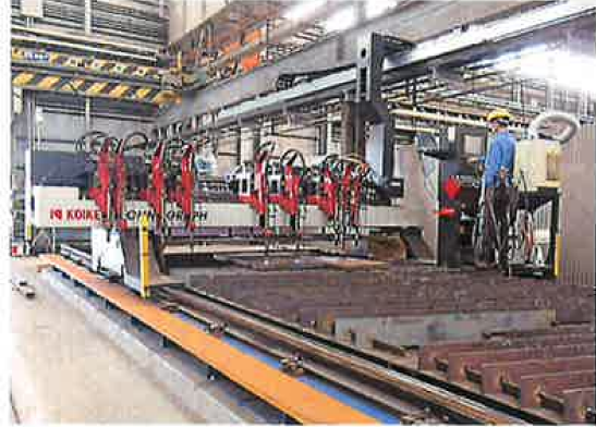
「超短工期」用に移設したNCガス溶断機
