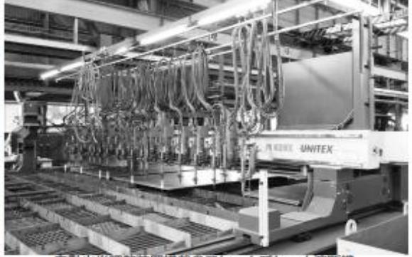
自動火炎調整装置搭載のフレームプレーナ溶断機
