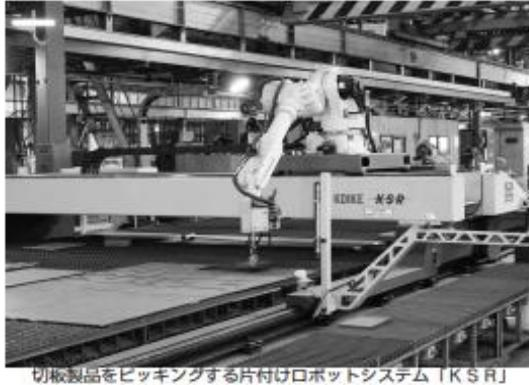
切板製品をピックアップする片付けロボットシステム「TKSR」
